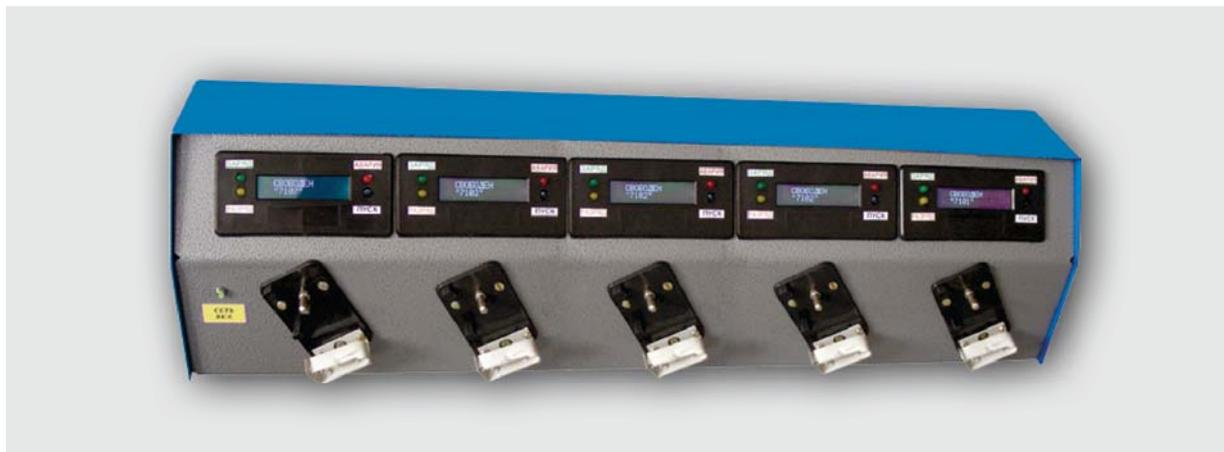
Автоматическая зарядная станция нового поколения АЗС-Заряд 5/5 не имеет аналогов на российском рынке и предназначена для автоматического заряда аккумуляторных батарей (АБ) головных светильников и приборов аэрогазового контроля. Осуществляет автоматизированный учет работы батареи в течение всего срока службы.
